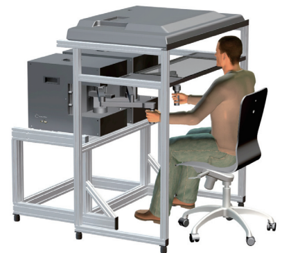
図1 ロボットアーム (KINARM, Bkin Technologies, Canada)
